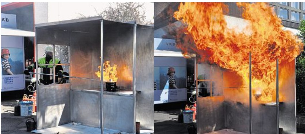
Dies passiert, wenn zuhause am eigenen Herd jemand einen Ölbrand am heimischen Topf mit Wasser löschen will, eine riesige Stichflamme, die die ganze Wohnung in Schutt und Asche versetzen kann. Anschaulich wurde die vielen Gefahren im Umgang mit Fetten und Öl gezeigt. Bleibt zu wünschen, dass dieser Fall den Lehrgangsteilnehmern erspart bleibt. (jr) Bilder: jr
